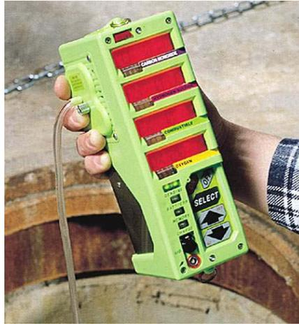
La mayoría de las pruebas atmosféricas se efectúan utilizando instrumentos de detección y lectura directa. Esto significa que los resultados de las pruebas pueden observarse directamente en la escala o patrón indicador, de manera que puede determinarse en cuestión de algunos segundos o minutos la presencia de peligros atmosféricos.
